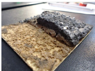
Hiiltynyt suoja-kerros poikkileikkattuna (paksuus 35 mm)
